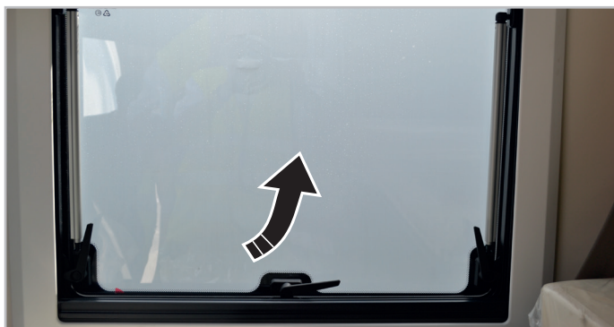
Kuva 6.7 - Öppning av fönster typ 3
