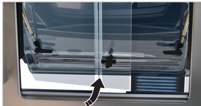
Kuva 6.5 - Öppning av fönster typ 2
