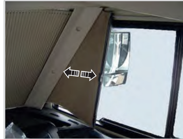
Fig.6.15 - Sammenleggbare blendingsgardiner for sidevinduer
