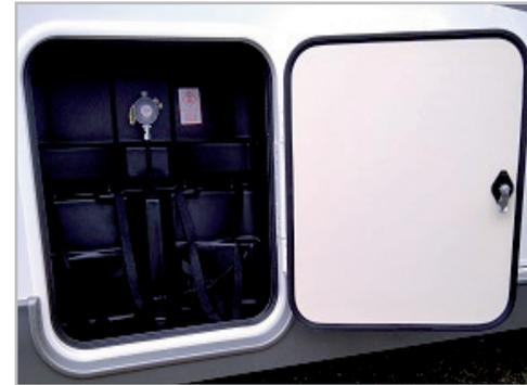
Fig. 6.30 - Compartimento para las bombonas de gas
