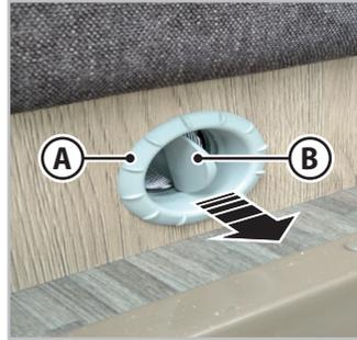
Fig. 6.46 - Salidas de ventilación
