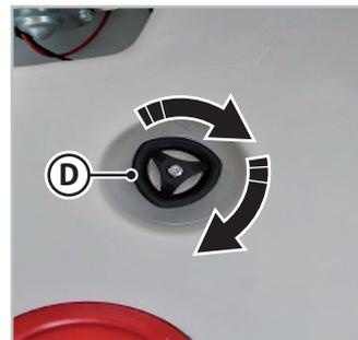
Fig. 6.37 - Válvula de vaciado de aguas limpias
