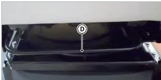
Fig. 3.7 - Palanca de deslizamiento del asiento
