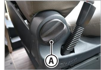
Fig.3.4 - Mando de regulación del respaldo
