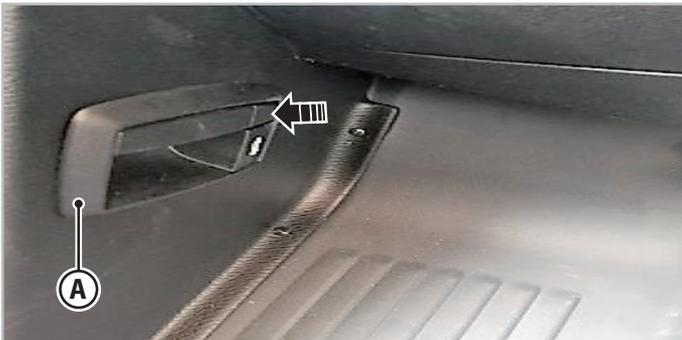
Fig. 5.9 - Palanca de apertura del capó - Tipo B
