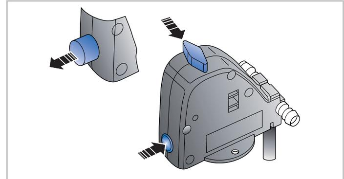
Fig.6.47 - Válvula de seguridad Combi
