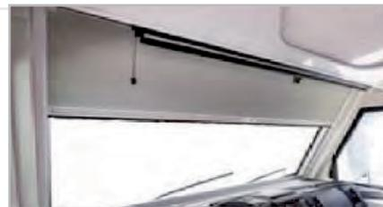
Fig.6.17 - Posiciones de la cortina oscurante del parabrisas
