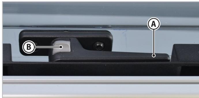
Fig.6.4 - Palanca de bloqueo de las ventanillas tipo 2
