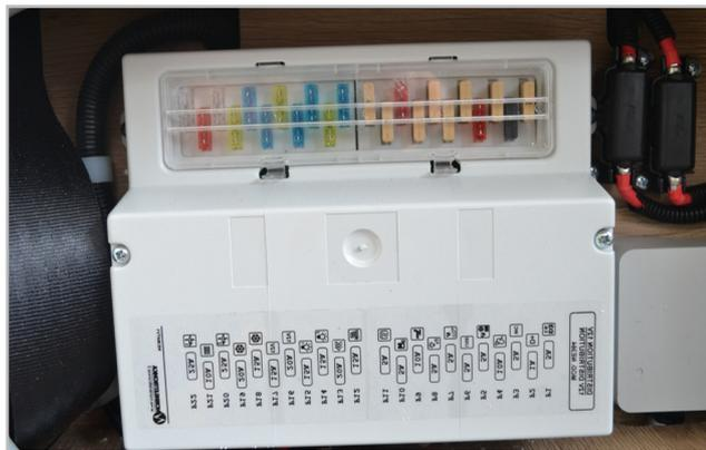
Fig. 7.3 - Portafusibles C/Poliswitch
