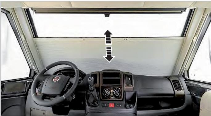
Abb. 6.16 - Faltbares Verdunkelungsrollo für die Windschutzscheibe
