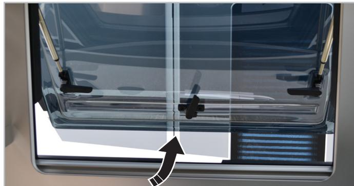
Abb. 6.5 - Öffnen der Fenster Typ 2
