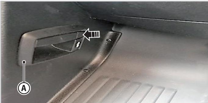
Abb. 5.9 - Hebel zum Öffnen der Motorhaube - Typ B
