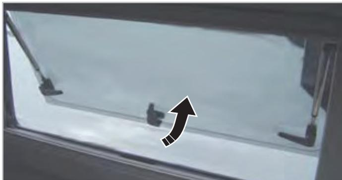
Abb. 6.3 - Öffnen der Fenster Typ 1
