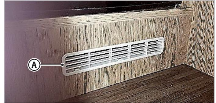
Abb. 6.1 - Permanente Belüftungsöffnungen
