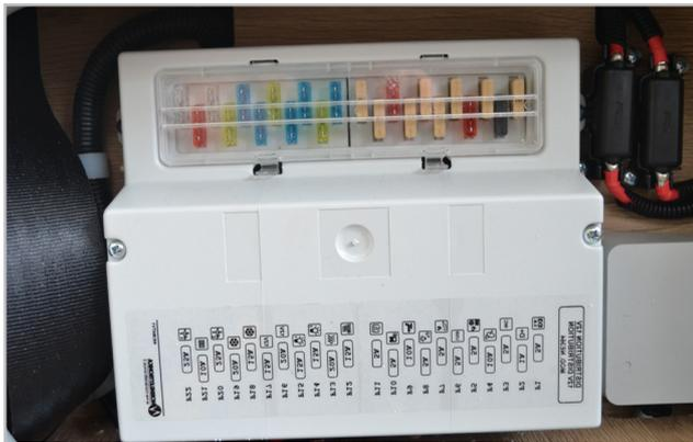
Abb. 7.3 - Sicherungshalter C/Poliswitch
