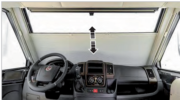
Ábra 6.16 - Összecsukható sötétítő a szélvédőhöz
