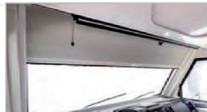
Ábra 6.17 - A szélvédő sötétítőjének állásai
