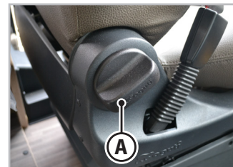
Ábra 3.4 - A háttámlát beállító gomb
