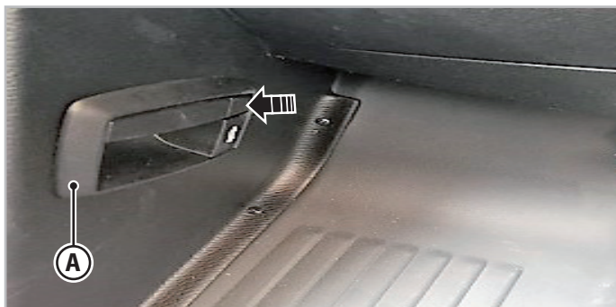
Ábra 5.9 - A motorháztetű kioldó karja - B típus
