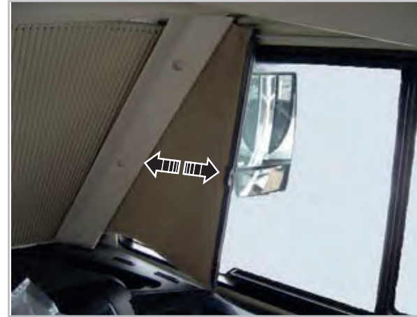
Ábra 6.15 - Összecsukható sötétítő függönyök az oldalsó ablakokhoz
