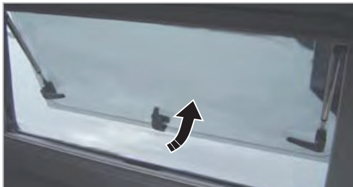
Ábra 6.3 - 1. típusú ablakok nyitása
