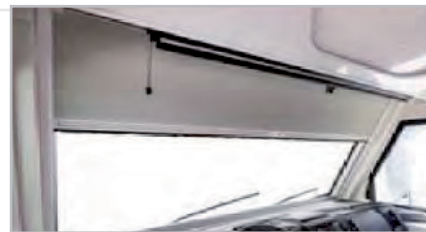
Sl. 6.17 - Položaji sjenila vjetrobranskog stakla
