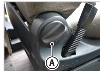
Fig.3.4 - Betjeningsanordning til justering af ryglænet
