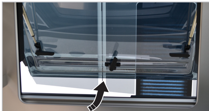
Фиг. 6.5 - Отваряне на прозорци тип 2
