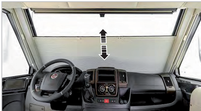
Fig. 6.16 - Tendina oscurante pieghevole per parabrezza
