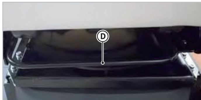
Fig.3.7 - Leva slittamento sedile
