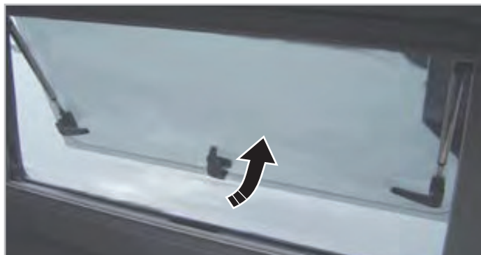
Fig. 6.3 - Apertura finestre tipo 1
