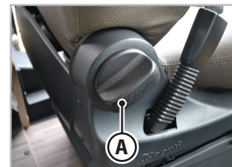
Fig.3.4 - Comando regolazione schienale
