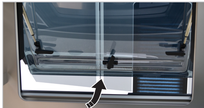
Fig. 6.5 - Apertura finestre tipo 2
